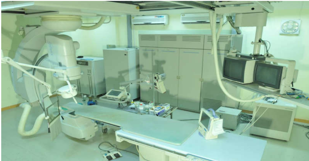
Hình 2.1. Máy chụp mạch kỹ thuật số Infinitive của hãng Toshiba
