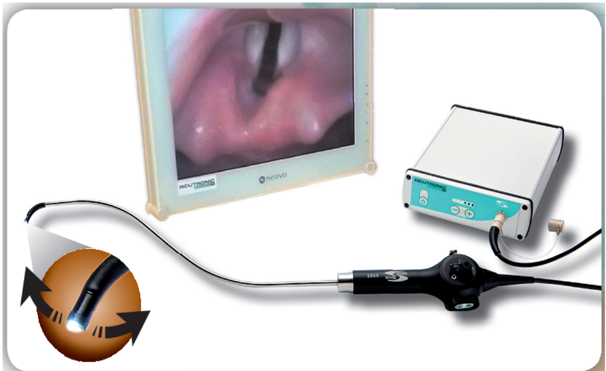
Hình 1.17. Hình ảnh bộ nội soi bán cứng [67] (Nguồn từ tham khảo [67])
