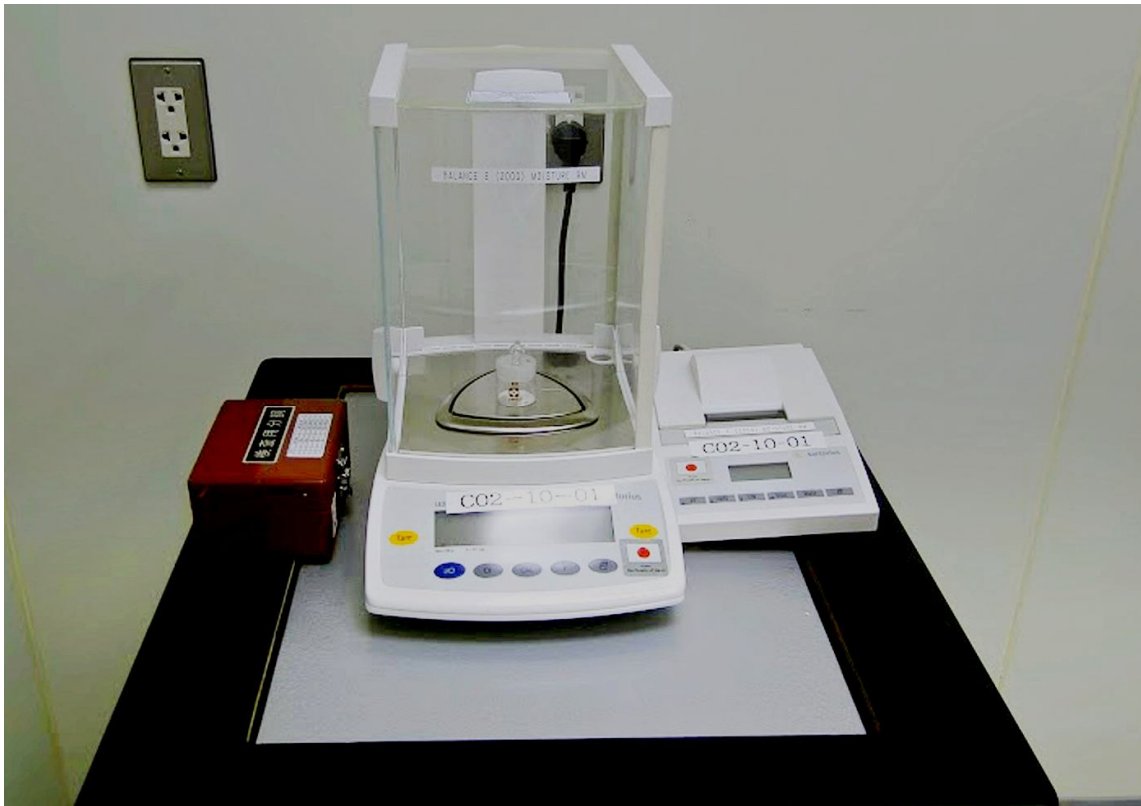
Hình 2.2: Cân sử dụng trong nghiên cứu được đặt trên bàn cát chống rung để giảm thiểu sai số, hộp bộ quả cân chuẩn (trái) và máy in kết quả (phải)
