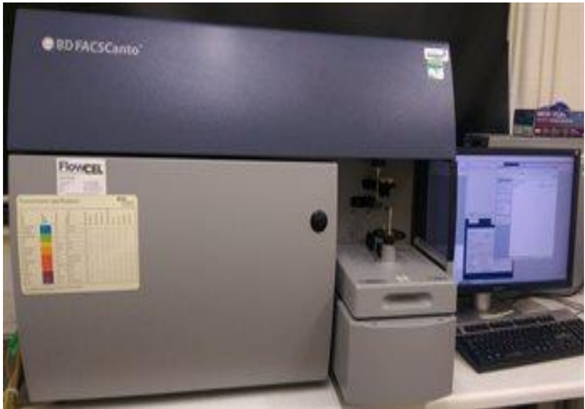
Hình 2.4. Máy phân tích tế bào dòng chảy FACSCanto II;
