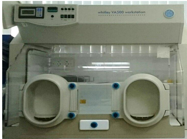
Hình 2.8. Hệ thống máy nuôi cấy vi khuẩn kỵ khí Whitley VA500
