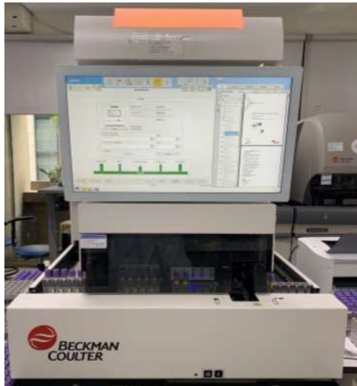
Hình 2.6. Máy đếm tế bào DxH 900 Beckman Coulter (xét nghiệm tổng phân tích tế bào máu)
