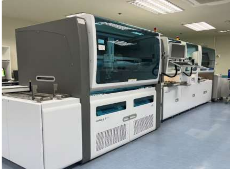
Hình 2.1. Máy ly tâm và xử lý mẫu xét nghiệm sàng lọc máu
