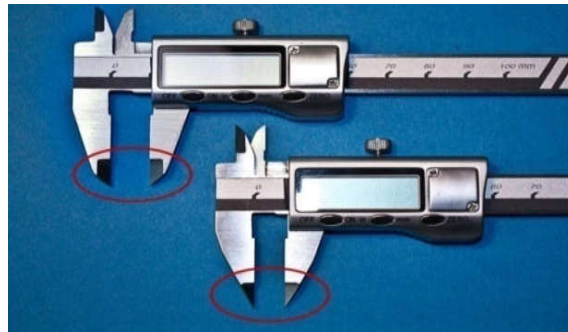
Hình 2.9. Thước trượt điện tử với hai loại đầu [17].
