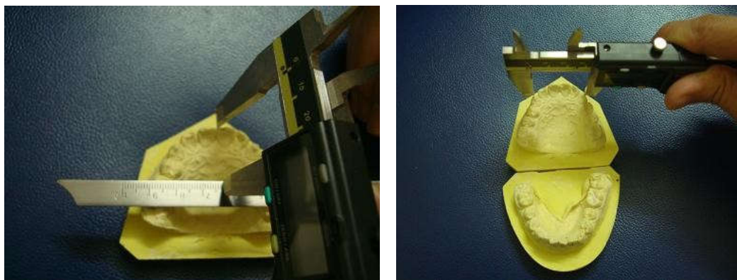
Hình 1.44. Đo mẫu hàm thạch cao bằng thước trượt điện tử [17].
