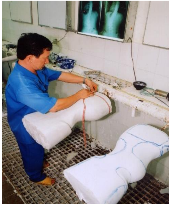
Hình 2.9. Tạo hình áo nẹp bằng phương pháp hút chân không
