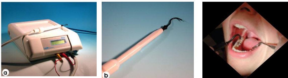
Hình 1.3: Thiết bị ECM. (a) Máy ECM, (b) Đầu đo của ECM [49]
