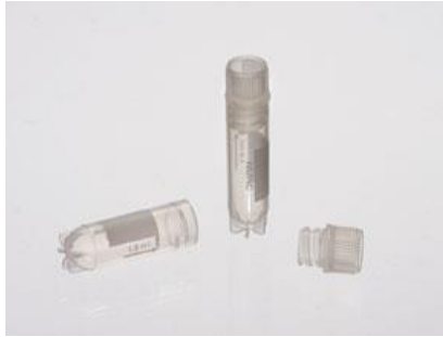
Hình 2.1. Tube trữ lạnh (cryotube)
