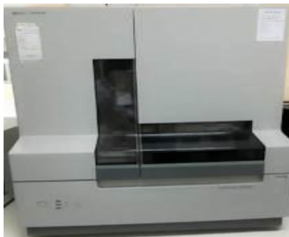
Hình 2.5: Máy xác định trình tự gen ABI PRISM 3100 Genetic Analyzer
