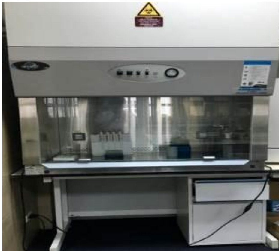
Hình 2.3: Máy tách mẫu LabGard Class II, Biological Safety Cabinets
