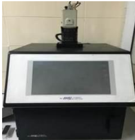
Hình 2.4: Hệ thống UPV chụp ảnh gel, xác định kích thước DNA
